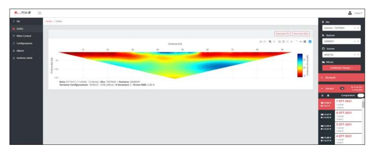
Possibilità di **calcolo** di una stima del **contenuto d'acqua** del suolo basata su una relazione derivata dai valori di resistività e di contenuto d'acqua di campioni estratti da un carotaggio nel sito d'indagine.
