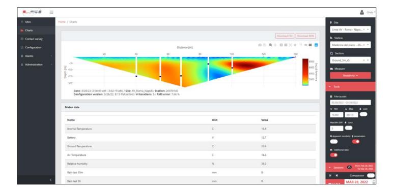
Visualizzazione dei dati addizionali: dati ambientali (provenienti da sensori meteorologici aggiunti al sistema) e dati piezometrici da piezometri collegati ad un data logger aggiuntivo collegato al sistema G.Re.T.A.
