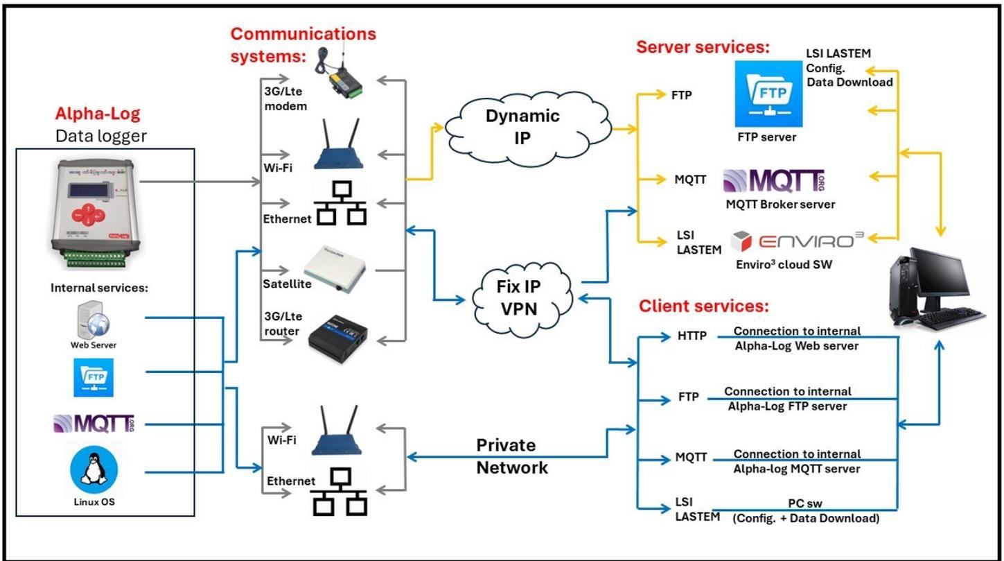
► In funzione del tipo di apparato di comunicazione scelto e dalla possibilità di avere comunicazioni solo in uscita dal data logger (Dynamic IP) oppure anche in entrata (Fix IP, VPN, Private Network), sarà possibile scegliere come e dove i dati saranno disponibili all'interno della rete.
