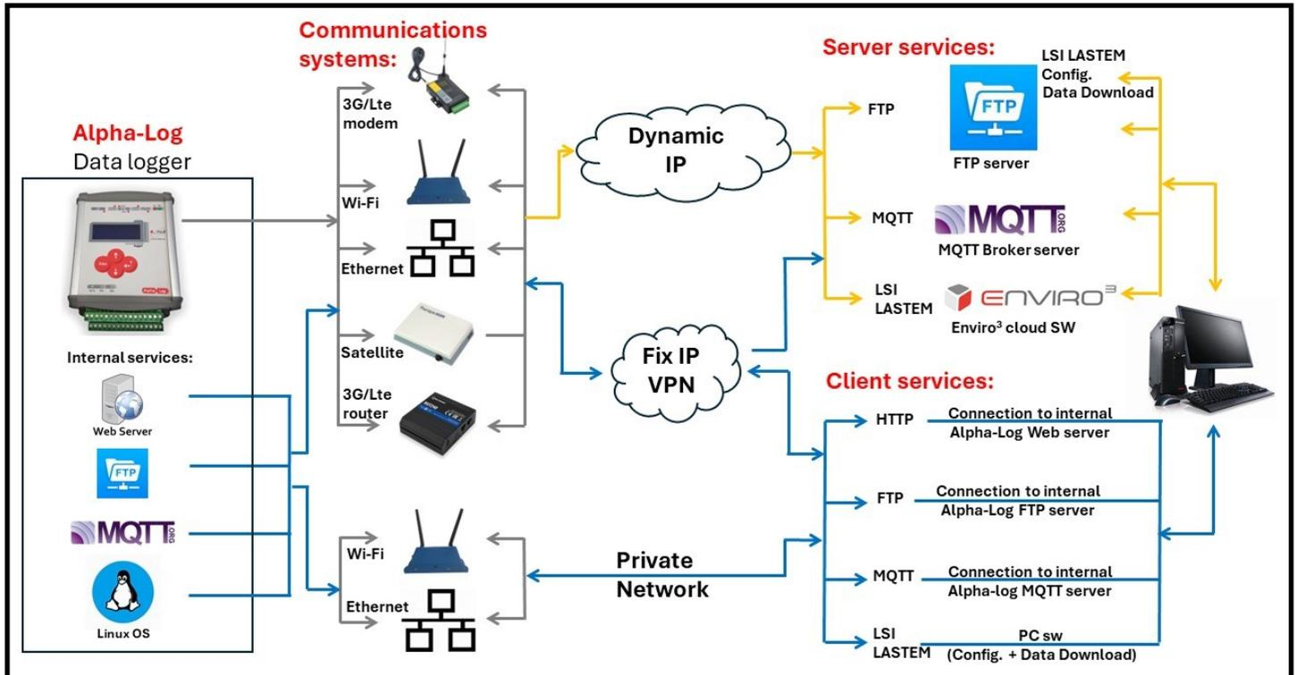
► In funzione del tipo di apparato di comunicazione scelto e dalla possibilità di avere comunicazioni solo in uscita dal data logger (Dynamic IP) oppure anche in entrata (Fix IP, VPN, Private Network), sarà possibile scegliere come e dove i dati saranno disponibili all'interno della rete.
