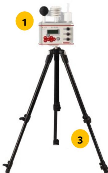
Il kit è composto dall'unità **Heat Shield (1)**. Sono disponibili diversi modelli di Heat Shield: con/senza tecnologia radio incorporata e con diversa dimensione del globo nero da 5 o 15 cm di diametro. La tecnologia radio può supportare fino a **due unità satellitari (2)** per calcolare il WBGT in posizioni diverse.
