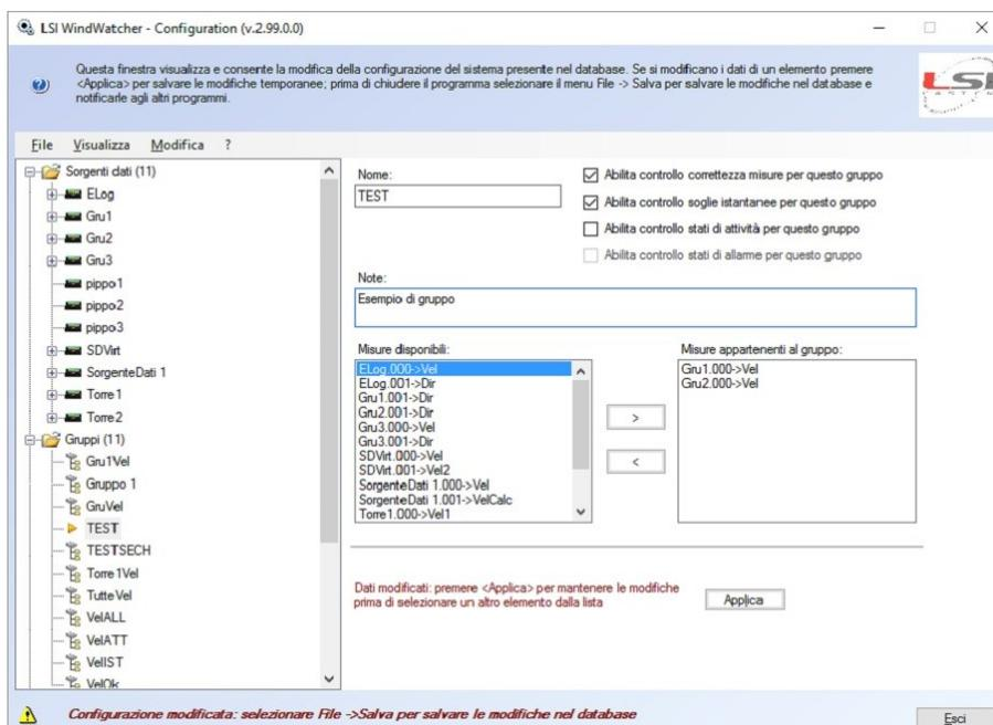
▶ *Configurazione estesa. Oltre alla gestione delle comunicazioni e al numero di punti di misura, permette il loro raggruppamento in gruppi e sotto-gruppi logici e la programmazione di logiche di allarme.*
