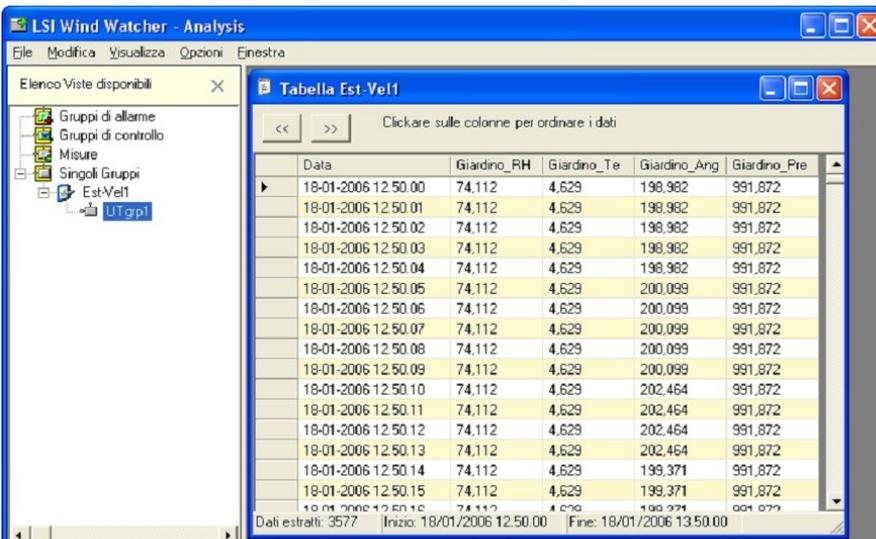
► Il database mantiene memoria di tutti i dati rilevati istante per istante dagli anemometri, delle condizioni di allarme o degli eventi di potenziale malfunzionamento verificatisi nel corso del tempo.
