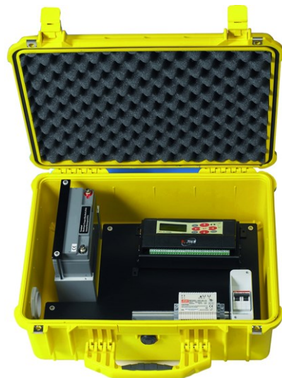
Custodia IP66 per applicazioni di monitoraggio portatili
