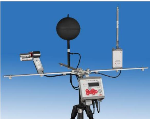
▶ Tipicamente M-Log (ELO009) viene utilizzato su un cavalletto portatile per misure microclimatiche per la valutazione del comfort e stress termico, qualità dell'aria, misure di ventilazione, misure termogrametriche per la valutazione dell'efficienza energetica degli edifici e collaudi termotecnici
