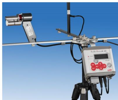
► *Il sensore psicrometrico ESU102A viene collegato all'acquisitore M-Log (ELO009). M-Log legge i valori di temperatura secca e umida e calcola l'Umidità Relativa e Punto di Rugiada utilizzando le formule descritte nella norma ISO7726.*
