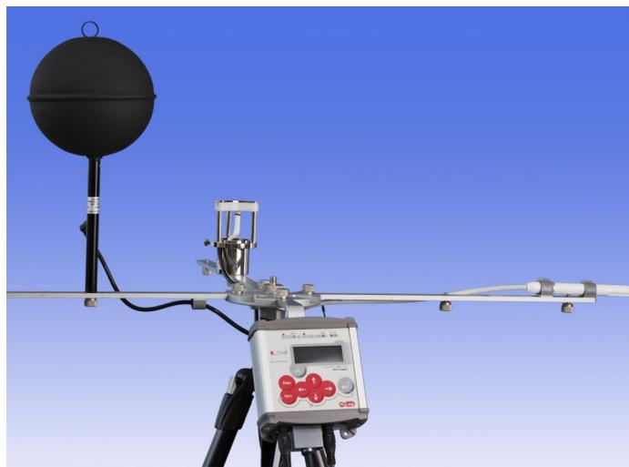
► LSI LASTEM propone una gamma di strumenti per uso professionale per valutare lo stress termico (stress da caldo e freddo) e il comfort termico. La temperatura di bulbo umido ( $T_{nw}$ ) è un'importante misura (insieme alla temperatura di globo e alla temperatura dell'aria) per il calcolo dell'indice di stress termico WBGT secondo lo standard ISO7243.
