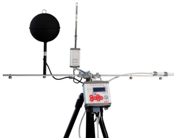
► LSI LASTEM fornisce una gamma di strumenti professionali per valutare lo stress termico (stress da caldo e freddo) e il comfort termico. La temperatura di globo (Tg) è un importante parametro (insieme a temperatura dell'aria & UR% e velocità dell'aria) necessario al calcolo degli indici microclimatici più utilizzati.
