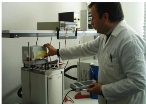
▶ LSI LASTEM è un laboratorio accreditato ISO17025 per misure di temperatura. Tutti i sensori prodotti sono testati nei nostri laboratori. LSI LASTEM fornisce Test Report per tutti i sensori, e, su richiesta, certificati di calibrazione secondo le norme ISO9001 o ISO17025 (vedere lista Accessori).
