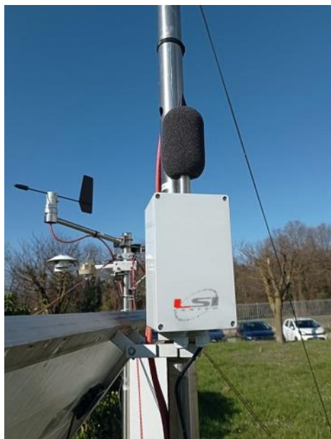
► Installazione outdoor su palo con apposita placca di montaggio
