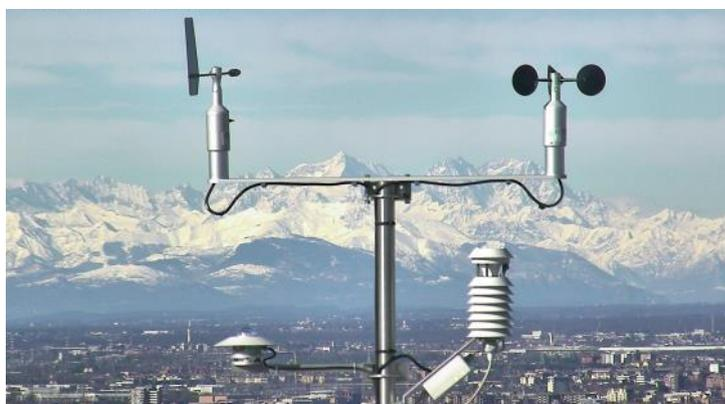
► Il sensore di velocità del vento può essere montato assieme al sensore di Direzione del vento, utilizzando la barra DYA046. Sulla stessa barra vi è spazio per altri sensori, come sensori di Temperature, Umidità Relativa e Radiometri.
