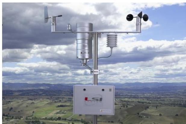
► Il sensore di velocità del vento DNA202.1 può essere montato assieme al sensore DNA212.1 di Direzione del vento, utilizzando la barra DYA046. Sulla stessa barra vi è spazio per altri sensori, come sensori di Temperatura, Umidità Relativa e Radiometri.
