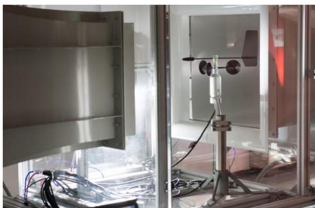
► LSI LASTEM dispone di un laboratorio accreditato ISO17025 per la misura della velocità dell'aria. Tutti i sensori sono testati in questo laboratorio. LSI LASTEM fornisce un Test report per qualunque sensore, e su richiesta, certificati di calibrazione ISO17025 o ISO9001 (vedere "Accessori").
