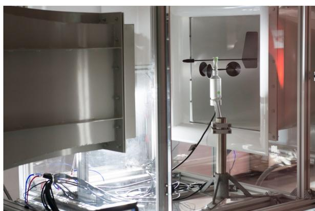
► LSI LASTEM è un laboratorio accreditato ISO17025 per la misura della velocità dell'aria. Tutti i sensori sono testati in questo laboratorio. LSI LASTEM fornisce un Test report per qualunque sensore, e su richiesta, certificati di calibrazione ISO17025 o ISO9001 (vedere "Accessori").
