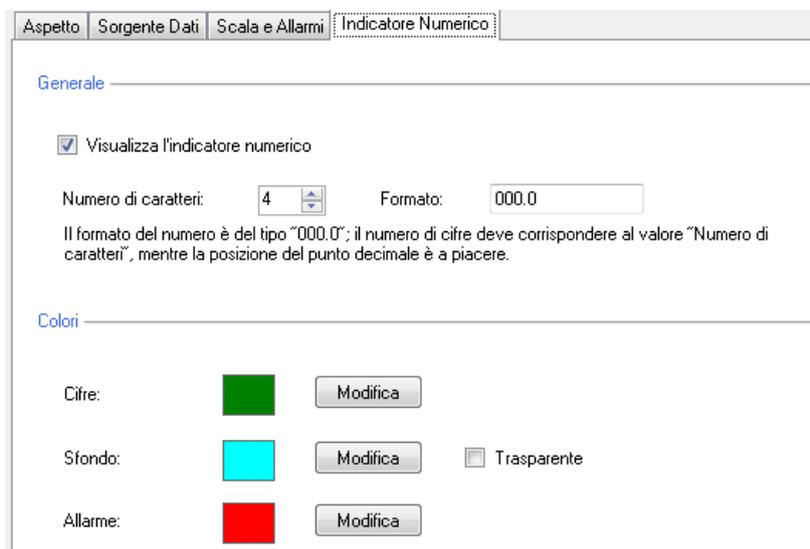
In particolare impostare il *Formato* del numero per determinare la posizione del separatore decimale, espresso nel formato “000.0”; il numero delle cifre deve corrispondere a quanto impostato in *Numero di caratteri*, mentre la posizione del punto decimale è a piacere.
