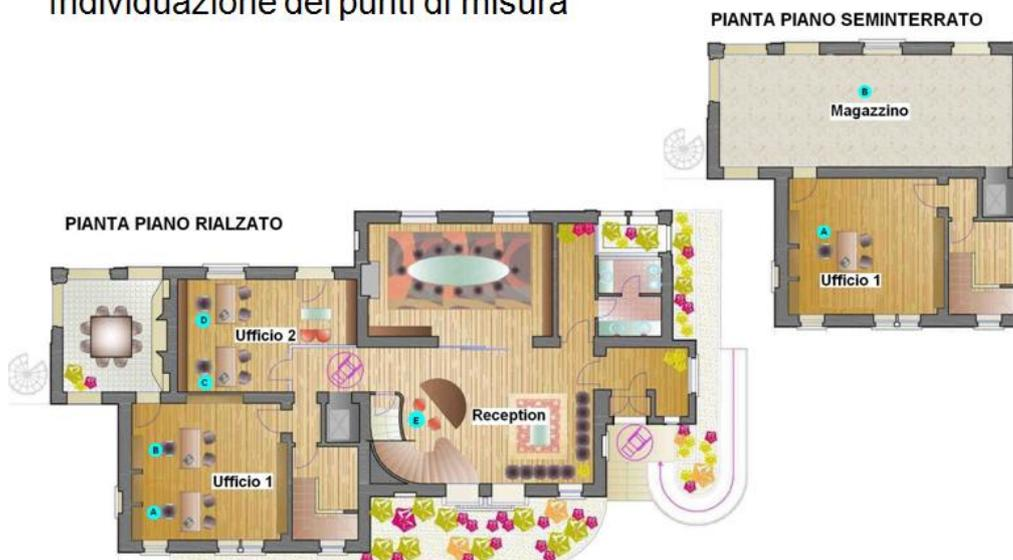
In una situazione di questo tipo, ad esempio, il progetto microclimatico conterrà due spazi principali, il *seminterrato* e il *piano rialzato*; ognuno di questi spazi (denominati nel programma *Sito*) conterrà alcuni altri spazi (*Ufficio 1* e *Magazzino* nel *Seminterrato*, *Ufficio R1* *Ufficio R2* e *Reception* nel *piano rialzato*); ognuno di questi spazi conterrà uno o più postazioni di misura dove verranno effettivamente svolti i calcoli.
