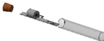
4. Rimuovere la parte superiore del guscio di protezione ed afferrare la testa dalla parte filettata. Manipolare il sensore solamente tramite questa parte.
