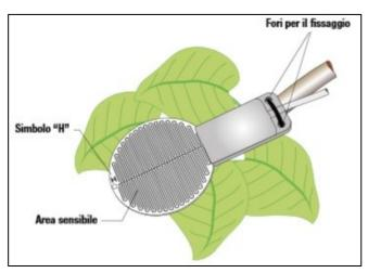
Il sensore deve risultare inclinato di circa 30÷45° rispetto al terreno, in modo da prevenire il ristagno della condensa o dell'acqua piovana sulla superficie sensibile e simulare la condizione reale del tipo di foglia della coltivazione in esame. Nel caso di installazione sul palo di una stazione meteorologica, fissare il sensore a una opportuna staffa inclinata.
