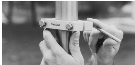
Fissare il sensore al collare avvitando i due bulloni indicati in figura.
