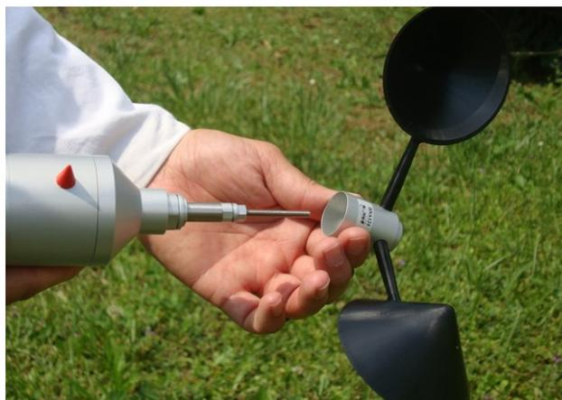
Montare il rotore DNA124 sul corpo del sensore.
