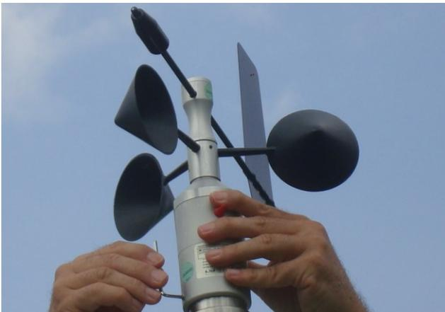
Montare il sensore sul palo di sostegno e stringere le viti.
