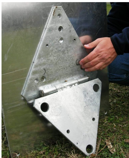
Fissaggio della base alla piastra DYA320
