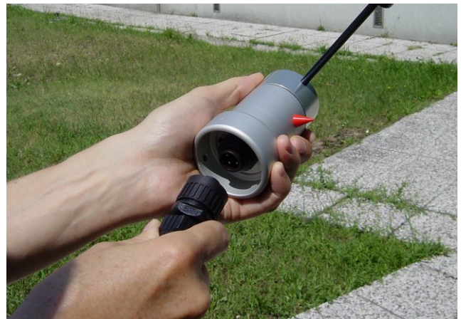
Connettere il cavo DWA5xx al sensore. Se non si ha il cavo DWA5xx ma il connettore MG2251, costruire il cavo come di seguito indicato.
