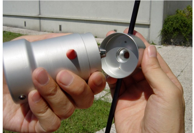
Montare la banderuola DNA218 sul corpo del sensore. Far combaciare il dente sul cono di rotazione sul corpo del sensore con l'incavo sulla banderuola.
