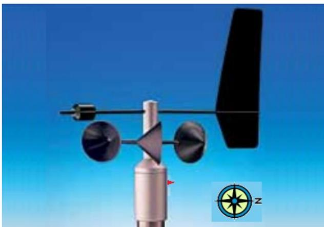
Nel fissare il sensore al palo, ricordarsi di puntare il nasello rosso a NORD per l'orientamento.
