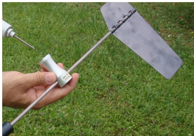
Montare la banderuola DNA127 sul corpo del sensore. Inserire la banderuola nell'albero. Tenere fermo l'albero e ruotare la banderuola esercitando una leggera pressione finché essa non andrà ad incastrarsi nel dado sottostante, fino quasi a toccare il rotore DNA124.
