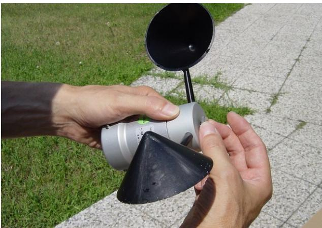
Fissare la vite del rotore. Attenzione! Non lasciare il sensore in funziona all'aperto senza il suo rotore.
