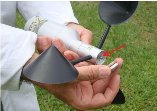
Montare la rondella e il dado (quelli indicati dalla freccia) e stringere. Infine, avvitare il coperchio di protezione.
