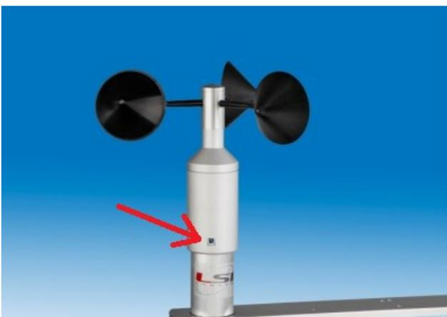
Montare il sensore sul palo di sostegno e stringere le viti (indicate dalla freccia).
