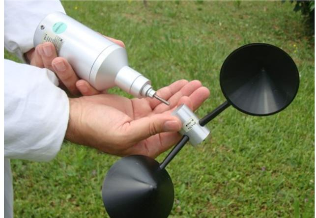
Montare il rotore DNA204 sul corpo del sensore. Tenere fermo l'albero e ruotare il rotore esercitando una leggera pressione finché esso non andrà ad incastrarsi nel dado sottostante.
