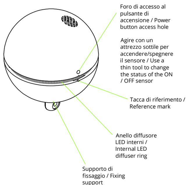
Il sensore utilizza una batteria ricaricabile collocata nella parte inferiore della scheda posta all'interno del sensore. Esso può funzionare collegato all'alimentazione tramite cavo micro-USB. In caso di sostituzione della batteria:
