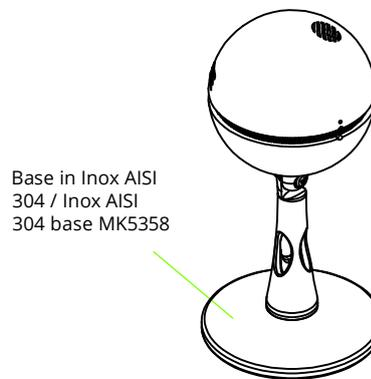
Utilizzando il gambo provvisto di dado Whitworth sarà possibile installare Sphensor™ su qualunque supporto per macchina fotografica (tripode, braccio snodato, ecc...) / Using the stem with Whitworth nut it will be possible to install Sphensor™ on any camera support (tripod, articulated arm, etc ...)
