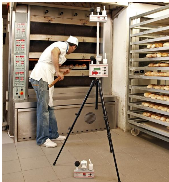
ELR600M / ELR610M: sensor de globo negro de 5 cm de diámetro
