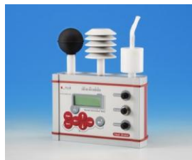
ELR600M / ELR610M: sensor de globo negro de 5 cm de diámetro
