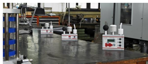
WBGT en tres niveles sobre la misma vertical Evaluaciones en tres posiciones del mismo ambiente
