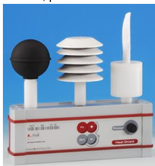
ELR610S: módulos satélite con sensor de globo negro de 5 cm de diámetro
