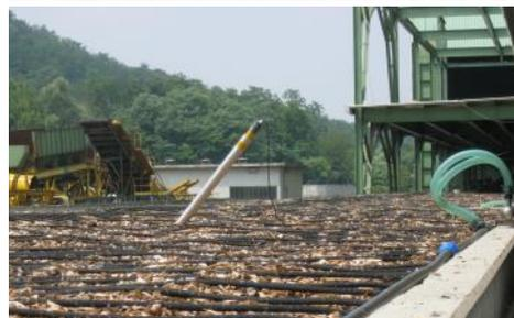
► La gamma dei sensori EXP è utilizzabile anche in misure sui letti dei Biofiltri. In questi casi, tipicamente, è utilizzato il sensore di Temperatura e Contenuto Idrico.
