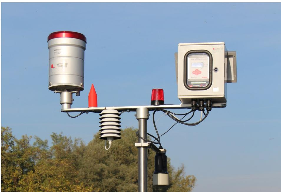
► Il sensore di distanza fronte temporalesco è particolarmente adatto per essere connesso al data-logger **Alpha-Log** e montato sulla barra DYAO46 (vedi foto), oppure su braccio DYAO32, per completare una soluzione di **early warning**.
