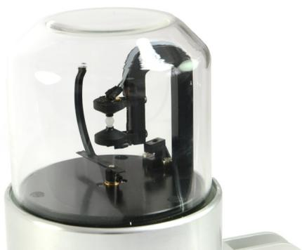
► Ad ogni rotazione della banda davanti all'elemento sensibile fotovoltaico, il sensore determina i due valori di insolazione (globale e diffusa), quando il valore della differenza tra le due misure, definibile come radiazione diretta, è maggiore di  $120 \text{ W/m}^2$  il sensore fornisce un valore ON allo stato di insolazione.
