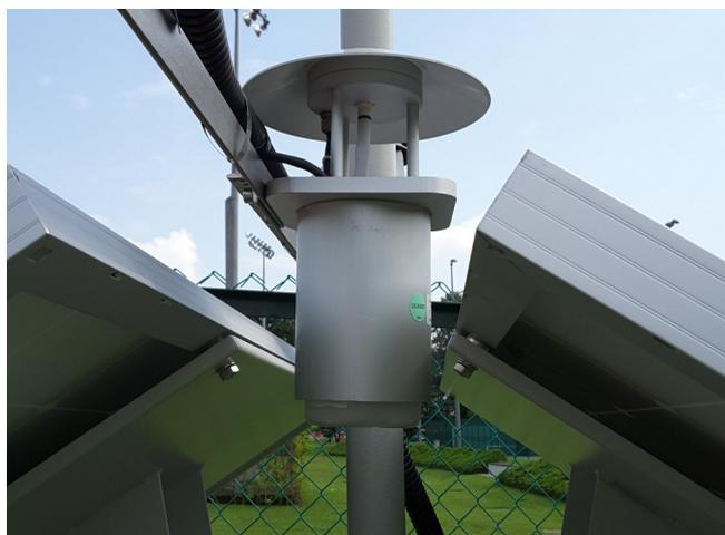
► La misura della temperatura di bulbo umido in outdoor, trova la sua più tipica applicazione nel calcolo dell'indice WBGT (ISO7243) quando è richiesto un monitoraggio continuativo all'esterno. In questi casi, sensori piccoli con poca acqua e non adeguatamente schermati, non sono adatti. I sensori DMA121A, DMA121.1, DMA122 e DMA122.1 costituiscono la soluzione "meteorologica" per questa misura.
